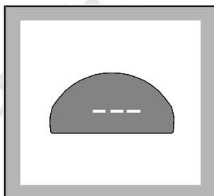
Если селектор программ находится в положении **O**, то на дисплее появятся три мигающих линии. При других положениях селектора на дисплее появится длительность соответствующей программы.
